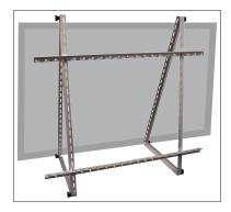
3. Befestigen Sie die Halterung am Untergrund. Nutzen Sie hierfür jeweils 3x Schraube M5 x 40 mm.
