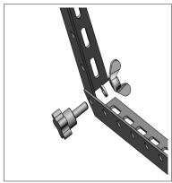
2. Montieren Sie an den beiden Dreiecksgestellen jeweils eine Aufhängung wie abgebildet. Befestigen Sie die Aufhängung mit jeweils 2x Schraube M6 x 20mm.
