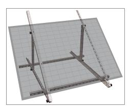
3. Befestigen Sie die Halterung am Untergrund. Nutzen Sie hierfür die Schrauben M5 x 40 mm.
